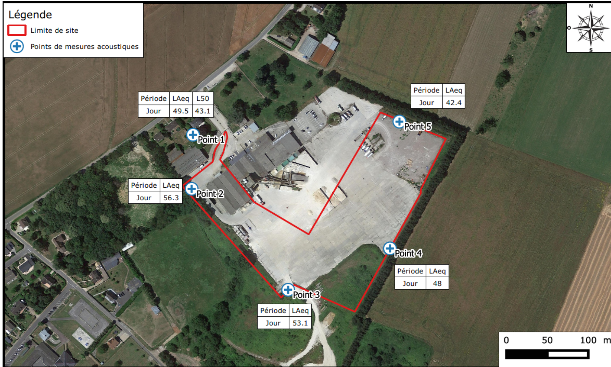
Figure 25 : Localisation et résultats des points de mesures acoustiques
